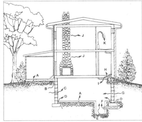
Основные пути проникновения радона: А — трещины в бетонных плитах; В — зазоры между кирпичной кладкой и фундаментом; С — поры и трещины в цементных блоках; D — швы в перекрытиях; E — радон из незащищенной грунт в отстойной колоде; F — просачивание через неплотные фитинги; G — открытые места в блочных стенах; H — строительные материалы; K — вода из скважин, водопроводов.
