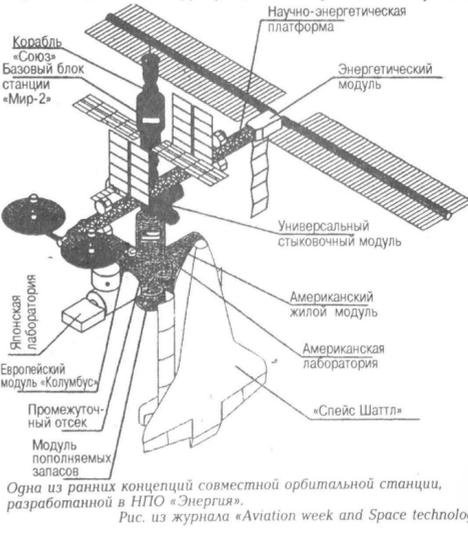
Одна из ранних концепций совместной орбитальной станции, разработанной в НПО «Энергия». Рис. из журнала «Aviation week and Space technology».
